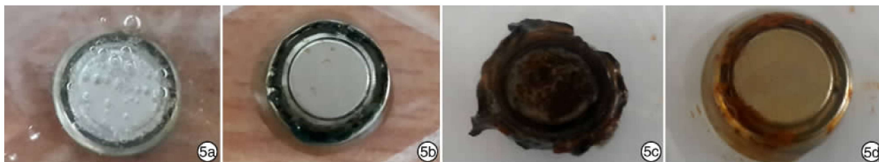
5a~c:生理盐水组电池即刻、1 h、24 h 的表现;5d:灭菌注射用水组电池 24 h 的表现。
