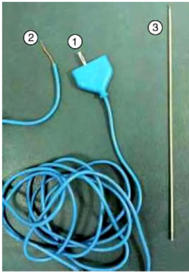
①接高频电刀系统主机端;②接喉针端;③喉针:尾端接②后安装于手柄上。
